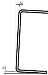
pav. 1 Profilio sraigtiškumo matavimas.
